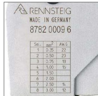
empfohlene Selector-Positionen direkt auf der Zange ablesbar
