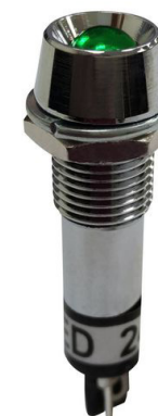
Abbildung 6 – LED-Anzeige, grün, 8 mm, 24 V, Lötmittel, RND Components
